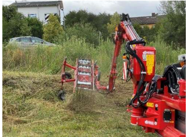
Abbildung 12: Tierschonender Balkenmäher als Anbaugerät am Ausleger.
