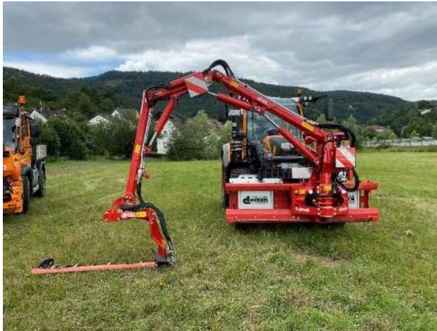
Abbildung 11: Striegel zum Ablegen des Mahdschwadens
